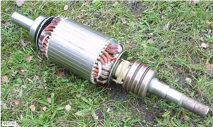
Bild 13.18: Rotor einer Schleifringläufermaschine 15 kW.
